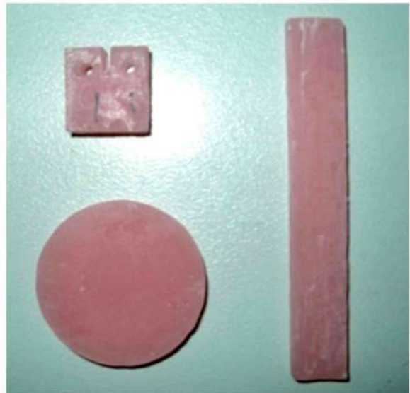
Рис. 1. Зразки базисних пластмас: зліва зверху – для дослідження ударної в'язкості, ліворуч унизу – для оцінки розчинності й водопоглинення, праворуч – для вивчення опору на злам)
