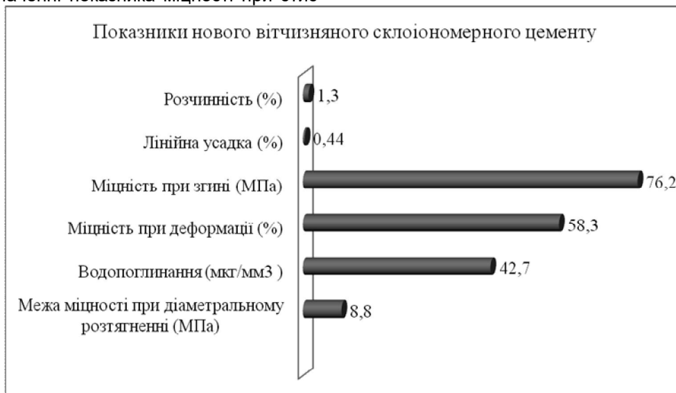
Рис. 3. Фізико-механічні властивості нового вітчизняного склоіономерного цементу
