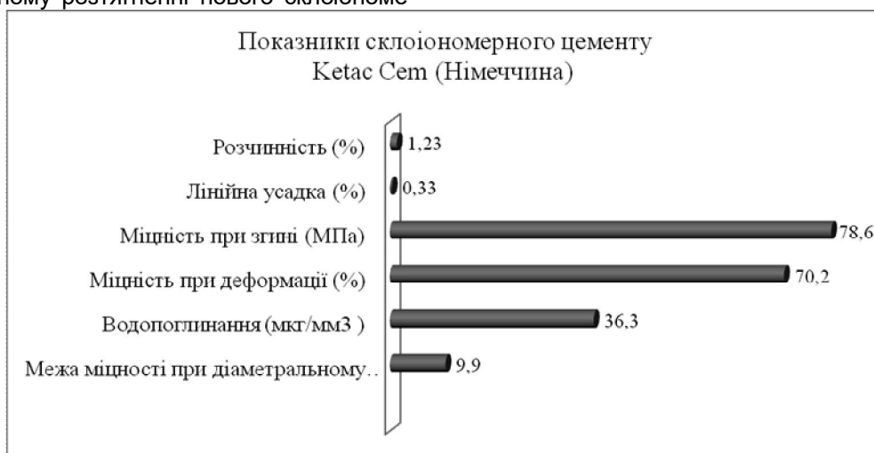
Рис. 1. Фізико-механічні властивості склоіономерного цементу «Ketac Cem» (Німеччина)
