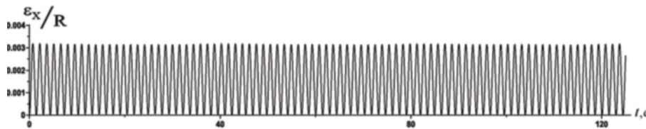
Рис. 7. Амплітуди коливань циліндра \varepsilon_x/R при C=500000 Н/м, \omega=4.14 , A=662 Н без пружини
