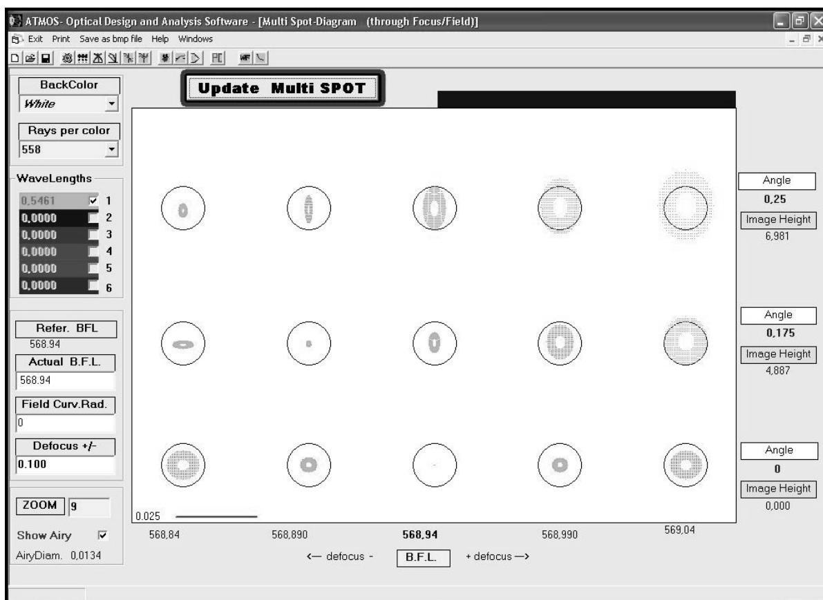
Рис. 2. Геометричні розміри зображення зорі при розфокусуванні на різній відстані від центра поля
