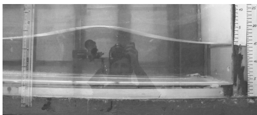
Рис. 2. Фотокадр поширення поодинокі хвилі над підводним уступом висотою h = 6 см при глибині води H = 17 см ( K_{\text{int}} = 0,35 )
