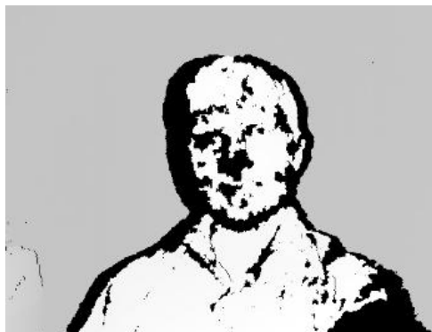
Рис. 3.1. Маска глибини з камери Kinect. (Світліше зображено ближчі частини зображення, темнішим – далші, чорні ділянки – це нерозпізнані частини)
