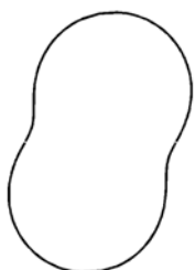
Рис. 10. Перетин діаграми спрямованості p_2 площиною, що проходить через координатну вісь X і вісь діаграми спрямованості ( Re = 300 ).
