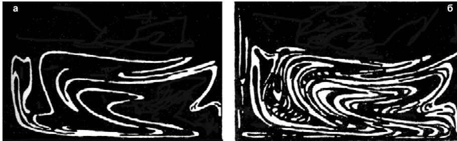
Рис. 1. Структури зсувної течії – складки ламінарної течії, що отримані при знакозмінному зсуванні рідини (гліцерин з алюмінієвим порошком) поздовж горизонтальної поверхні у прямокутній камері: а – 5 циклів, б – 10 циклів.
