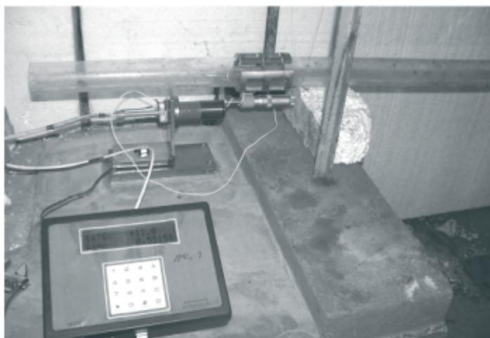
Рис. 2. Вимірювальний блок деформометричної системи з ємнісним датчиком на "короткому" (L=6,5 м, аз. 52°) деформографі в штольні РГС "Берегове" (а) та апаратура геотермічного моніторингу для РГС "Берегове" з кварцовим геотемпературним датчиком (структурно-функціональна блок-схема)
