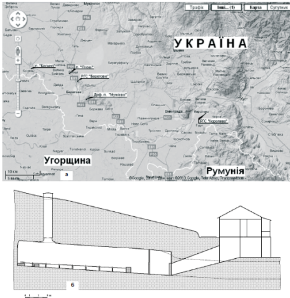
Рис. 1. Розташування пунктів геофізичних спостережень у центральній частині Закарпаття (а) (на картооснові Google) та розріз штольні РГС "Берегове" (б) (показано розташування деформографів)
