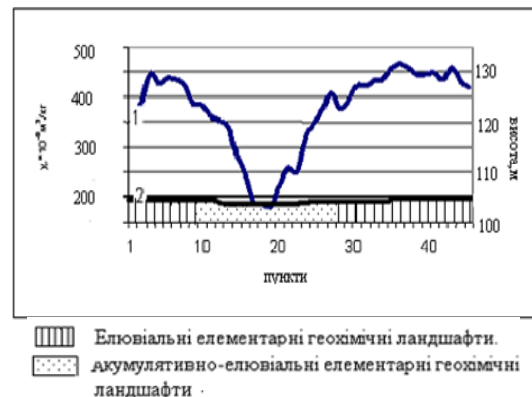
Рис 2. Магнітна сприйнятливість ґрунтів прохідної долини з гідроморфною ділянкою (Лохвицький район Полтавської області): 1 – графік значень магнітної сприйнятливості профілю, 2 – схема рельєфу профілю
