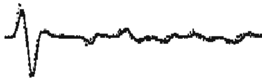
Рис. 3. Накладання синтетичних сейсмограм отриманих рефлективним та FCT методами для моделі середовища із табл. 1 та із використанням часової функції у вогнищі (16) [ 18]
