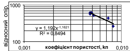
Рис. 1. Кореляційна залежність між коефіцієнтом пористості ( k_p ) і відносним електричним опором ( P ) – рівняння Арчі-Дахнова (лабораторні умови): а – пісковики, б – вапняки
