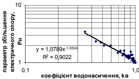
Рис. 2. Кореляційна залежність між коефіцієнтом водонасичення ( k_v ) та параметром збільшення електричного опору ( P_H ): а – пісковики, б – вапняки
