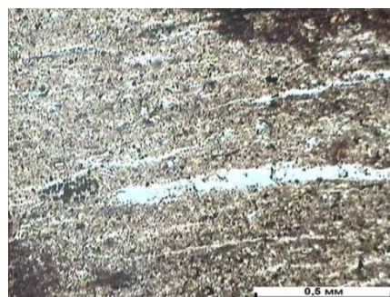
Рис. 4. Мікротріщинки у шліфі 13 ЄВ ( \times 4 )
