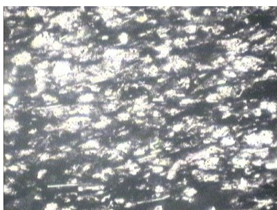
Рис. 3. Збагачений ОР чорний сланець (св. Ніжинська-338, обр. 61 НЖ, інт. 3075–3084 м, візейський ярус, \times 10 )
