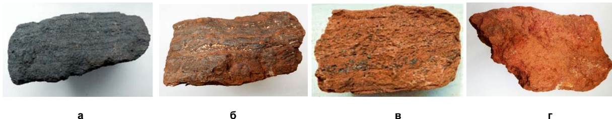
Рис. 1. Основные минеральные разновидности богатых руд входящих в состав отсева ДСФ: а – мартитовая ("синька"); б – дисперсногематит-мартитовая ("краско-синька"); в – мартит-дисперсногематитовая ("синько-краска"); г – каолинит-дисперсногематитовая ("краска").
