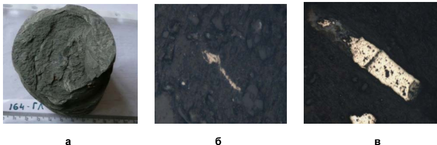
Рис. 4. Керн (а) и аншлифы (б, в) скважины Голицына-9, инт. 2100 м: б – аншлиф 164 ГЛ: колодетринит, антрацит; в – аншлиф 164 ГЛ: пирит инкрустирует витродетринит
