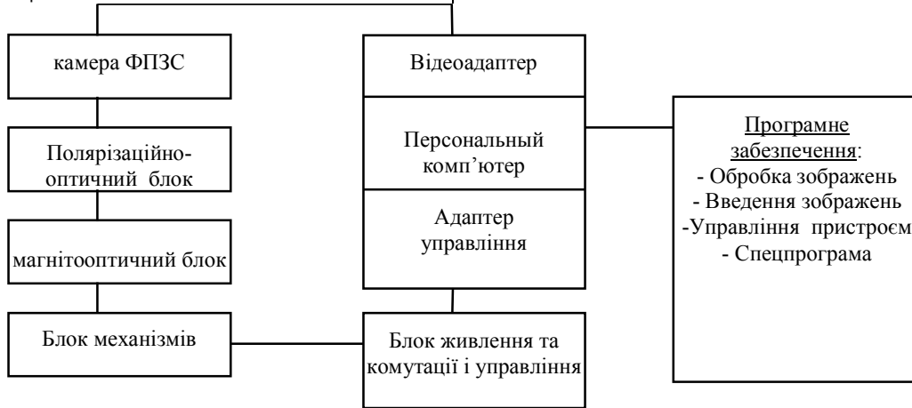
Рис. 5. Структурна схема магнітооптичного програмно-апаратного пристрою для вирішення завдань ТЗІ, яка записана на гнучких магнітних дисках
