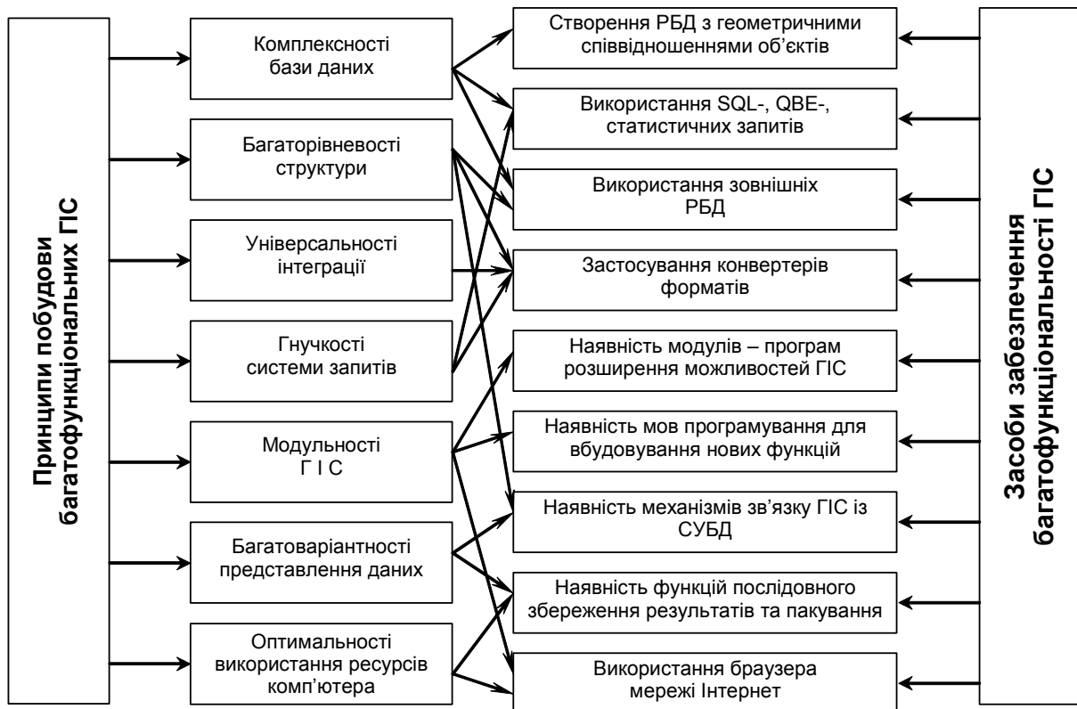
Рис. 1. Структурно-графічна модель поєднання принципів створення та засобів забезпечення багатofункціональності ГІС.
