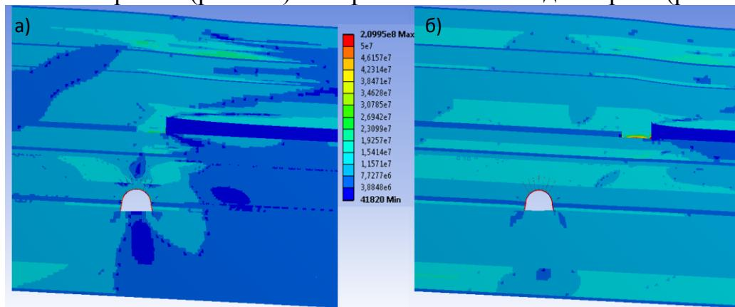
Рис. 1. Эпюры интенсивности напряжений  $\sigma$  поперечного сечения модели при разном положении очистного забоя:
