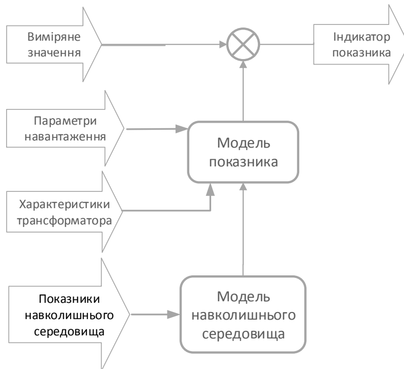
Рис. 2. Структура модуля аналізу параметрів трансформатора
