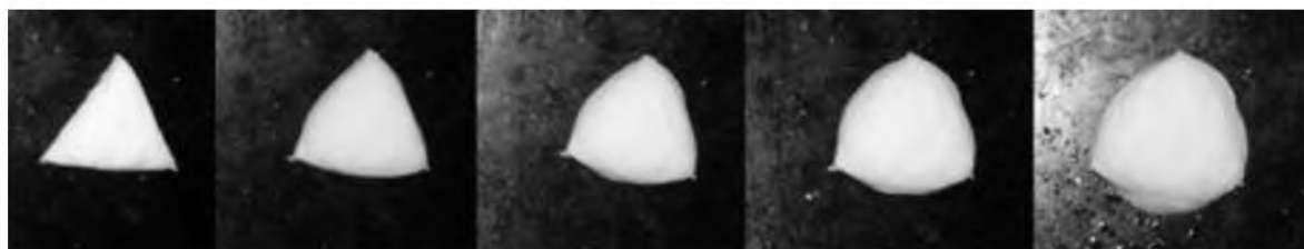
Рис. 3 – Моделювання змінення форми виробу під час спінювання
