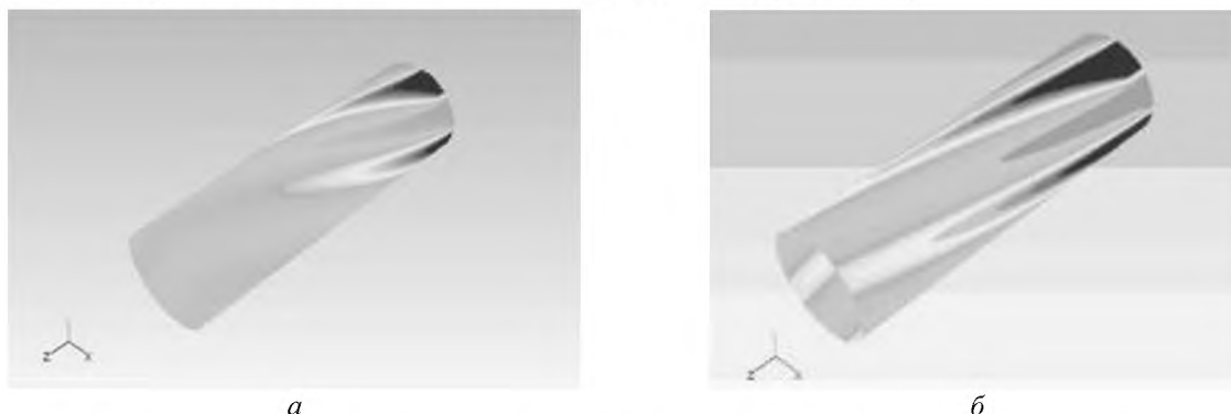
Рис. 2 – Розподіл матеріалу в середовищі в радіальній площині R3 (рис. 1, а) за співвідношення в'язкості 1:1 та обертової швидкості внутрішнього циліндра 16 (а) і 4 рад/с (б)
