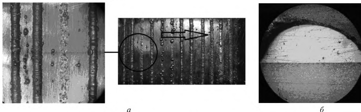
Рис. 6 – Валики і шліф із Бр010 ( d_n = 3 мм; оброблення за стрілкою): a - \times 32, v = 0,2 м/хв., P = 300 Вт; b - \times 100, v = 0,1 м/хв., P = 500 Вт, V_a = 7 л/хв.
