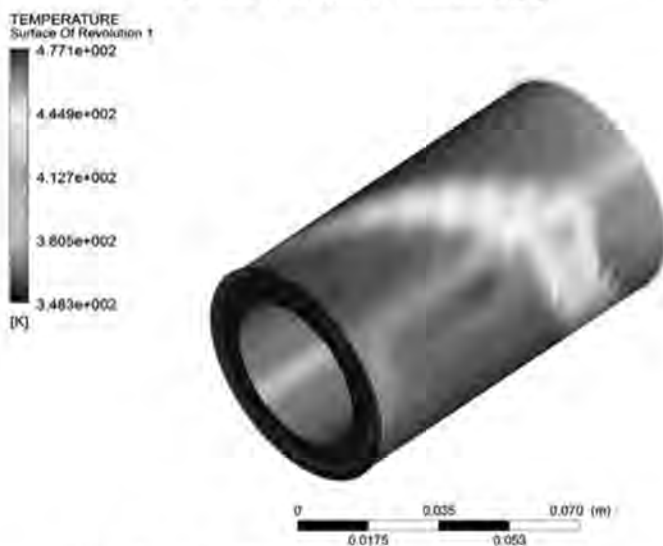
Рис. 3 – Розподіл температур у поздовжньому циліндричному перерізі робочого каналу на відстані 0,5 мм за швидкості обертання 60 \text{ хв}^{-1}
