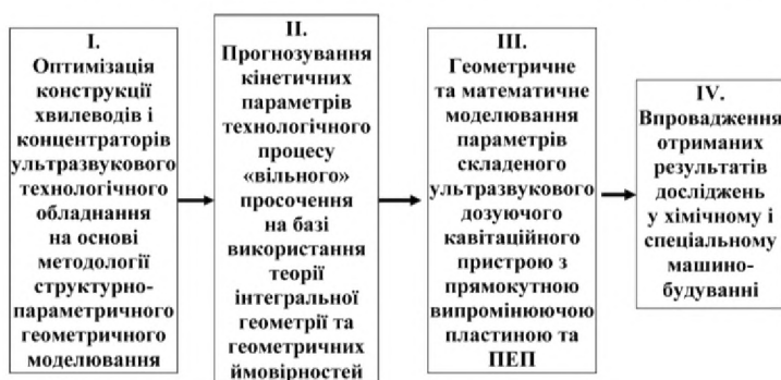
Рис. 3 – Послідовність досліджень з конструкторсько-технологічного проектування технічних засобів для одержання реактопластичних КВМ
