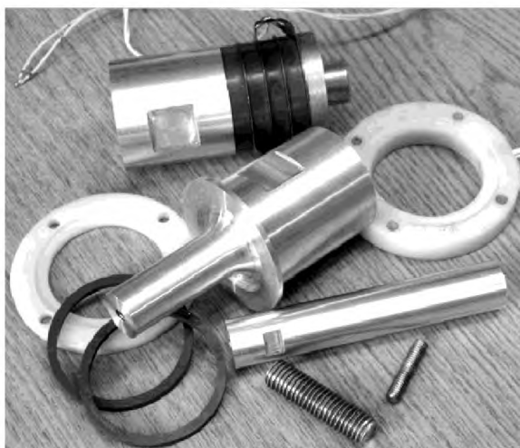
Рис. 2 – Складові елементи типового однохвильового УЗ-диспергатора, виконаного з симетричним пакетним ПЕП [5]
