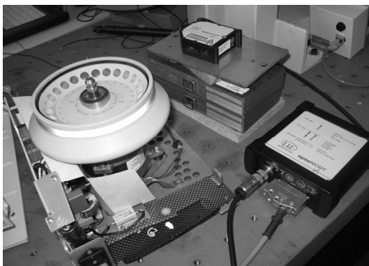
Рис. 9. Стенд експериментального визначення залежності власних частот від частоти обертання
