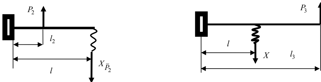
Рис. 5. Розрахункова схема від одиничної сили для анкера Рис. 6. Розрахункова схема від одиничної сили для ротора
