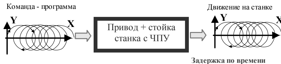
Рис. 3. Искажение параметров движения по трохойдальной траектории
