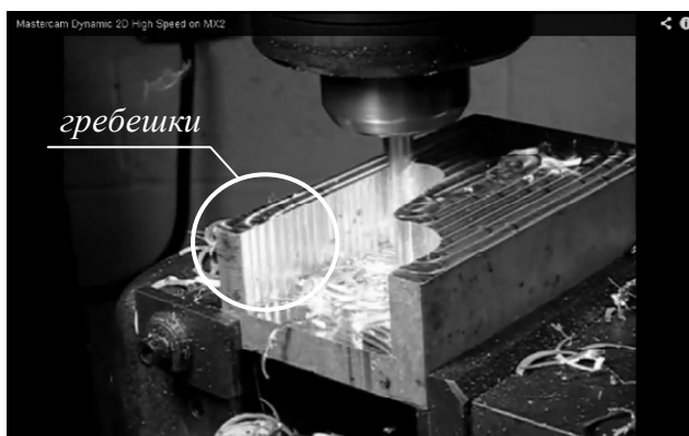
Рис. 4. Поверхность детали после трохойдального фрезерования
