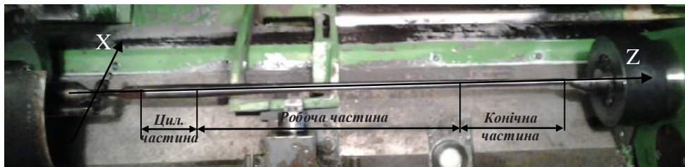
Рис.1. Оправка стану ХПТ в робочій зоні верстата
