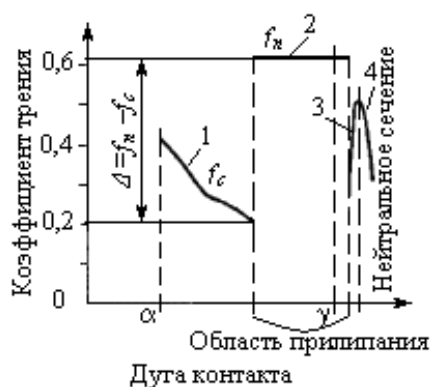
Рис. 2. Гипотетическая зависимость изменения коэффициента трения по дуге контакта
