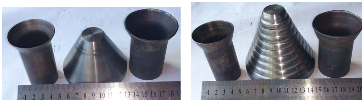
Рис. 9. Заготовки після роздачі традиційним пуансоном та зпрофільованим пуансоном (ліворуч від пуансонів показані заготовки зі сталі 12X18H10T, праворуч – зі сталі 10)
