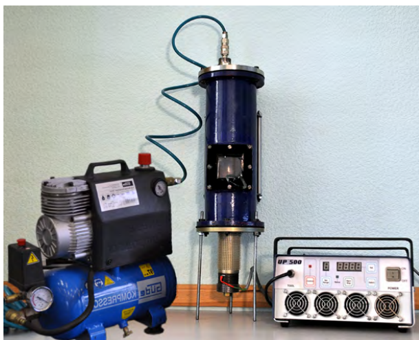
Рис. 8. Експериментальний стенд для дослідження продуктивності отримання аерозолі при надлишковому тиску в камері, де в замкненому об'ємі знаходиться тільки розпилююча поверхня диспергатора та його схема (1 – вібруюча поверхня; 2 – трансформатор коливальної швидкості; 3 – диспергатор; 4 – об'єм рідини, що подається; 5 – резервуар для рідини, яка переливається; 6 – об'єм рідини, яка переливається; 7 – герметична камера; 8 – підставка для підтримки диспергатора; СК – система керування)
