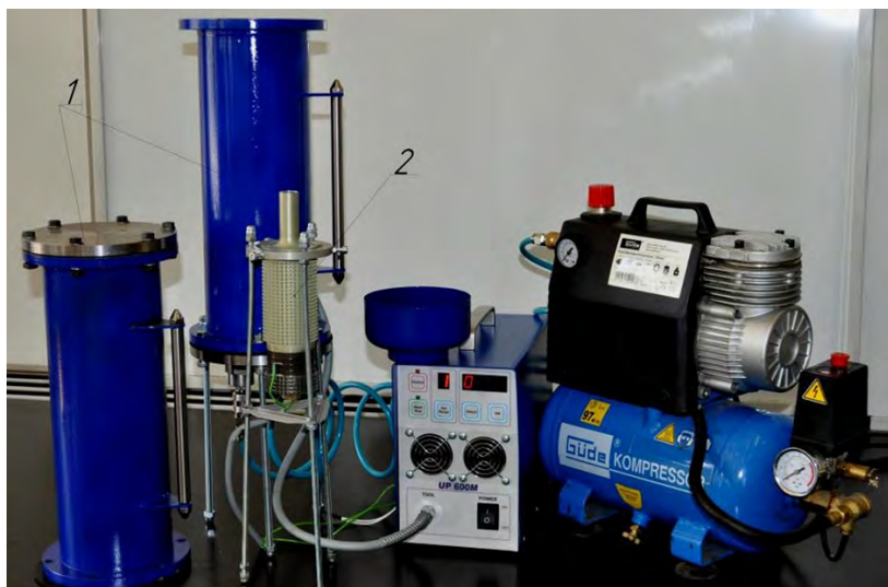
Рис. 1. Експериментальний стенд для дослідження розміру аерозолі в камері з надлишковим тиском
