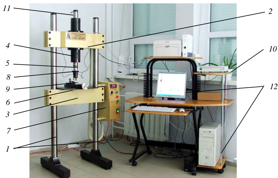
Рис. 2. Універсальна випробувальна машина для індувентування металів кулькою із твердого сплаву: 1 – колони, 2 і 3 – верхня і нижня траверси; 4 – пристій навантаження; 5 – шток, що передає навантаження; 6 – координатний столик; 7 – блок управління; 8 і 9 – датчики вимірювання навантаження і глибини вдавлювання індувентора; 10 – АЦП перетворювач; 11 – датчик вимірювання положення штока навантаження; 2 – персональний комп'ютер
