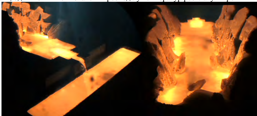
Рис. 1. Нерівномірно прогріте дзеркало розплаву в проміжній ємності та кристалізаторі
