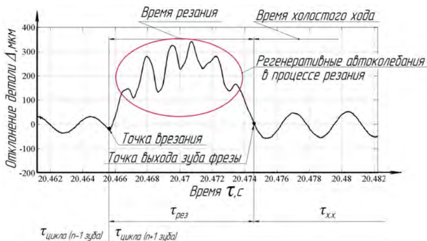
Рис. 6. Базовый фрагмент осциллограммы отклонения тонкостенной детали при фрезеровании с постоянной частотой вращения шпинделя
