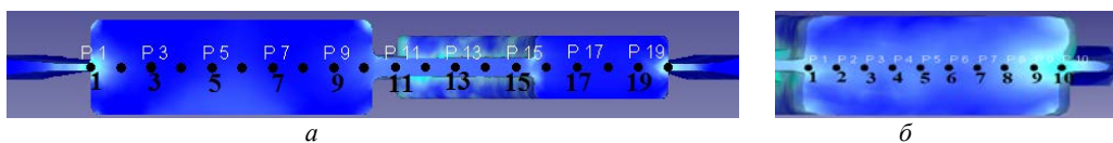
Рис. 7. Точечная схема для измерения НДС в указанных сечениях: а – сечение А-А; б – сечение Б-Б
