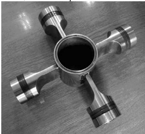
Рис. 1. Ультразвуковой кавитатор резонансного типа
