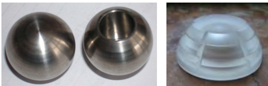
Рис. 3. Экспериментальные образцы титановой головки и сапфировой чашки для эндопротеза тазобедренного сустава
