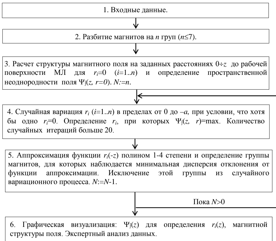
Рис. 5. Алгоритм определения расстояний r_i групп магнитов до рабочей поверхности МЛ с целью синтеза структуры магнитного поля с максимальной пространственной неоднородностью
