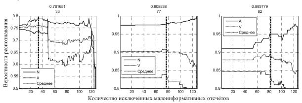
Рис. 8. Вероятности распознавания комплексов в зависимости от числа исключённых отсчётов для портретов в виде корреляционных функций сигналов
