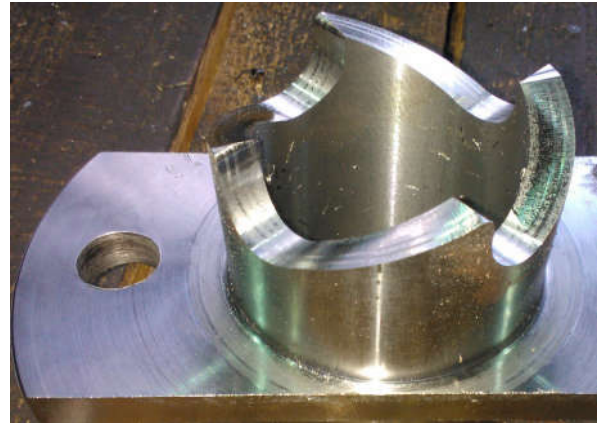
Рис. 9. Поверхности обкатки кулачка, изготовленного с «приблизительным» сопряжением после работы в механизме подъема
