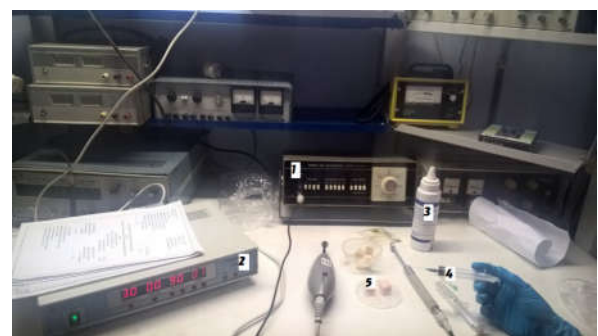
Рис. 2. Експериментальна установка: 1 – УЗ генератор «УЗТ-1.01-Ф»; 2 – комбінований фізіотерапевтичний апарат «МІТ-11»; 3 – контактний гель; 4 – фармакологічний препарат; 5 – біологічний об'єкт
