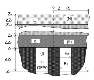
Рис. 1. Геометрическая схема измерений с помощью ОКС:  $R_1$ — внутренний радиус коаксиальной линии;  $R_2$  — внешний
