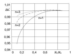
Рис. 2. Асимптотическое приближение корней собственных функций коаксиальной линии
