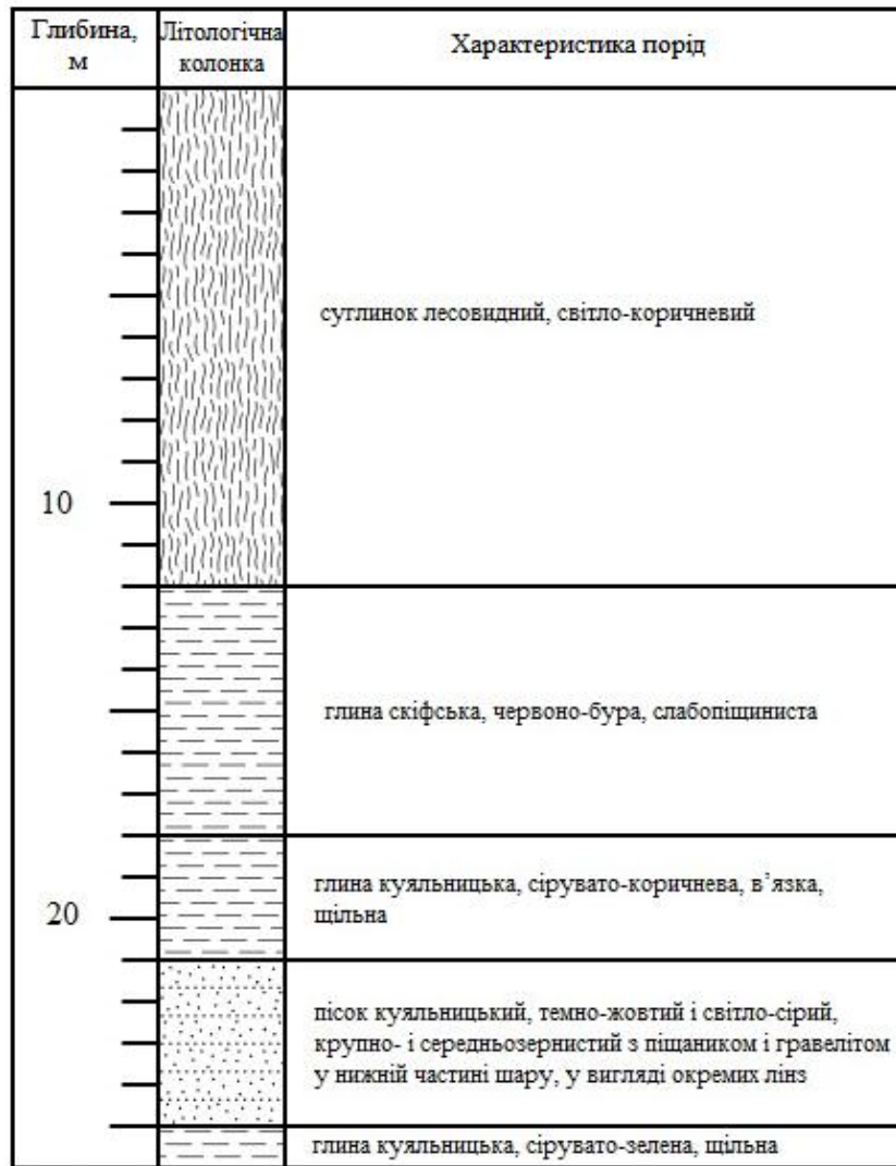
Рис. 2. Літологічний розріз західної ділянки Бердянського літодинамічного вузла (навпроти села Шевченка Бердянського району) [18]
