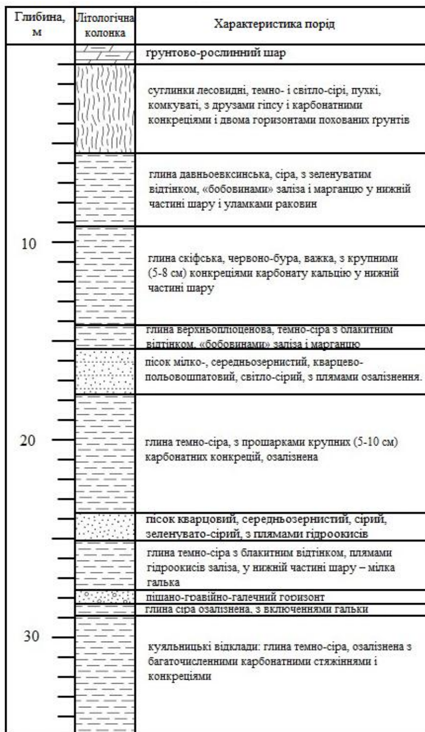
Рис. 1. Літологічний розріз східної ділянки Бердянського літодинамічного вузла (південний захід від села Куликівське Бердянського району) [18]
