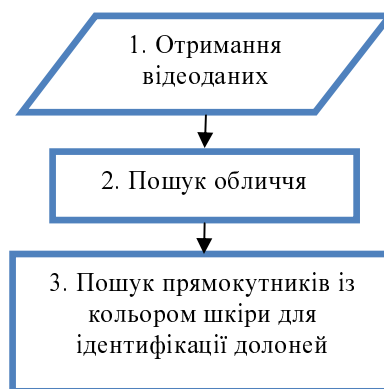
Рис. 1. Схема процесу визначення положення обличчя та положення долоней на відеозображенні.
