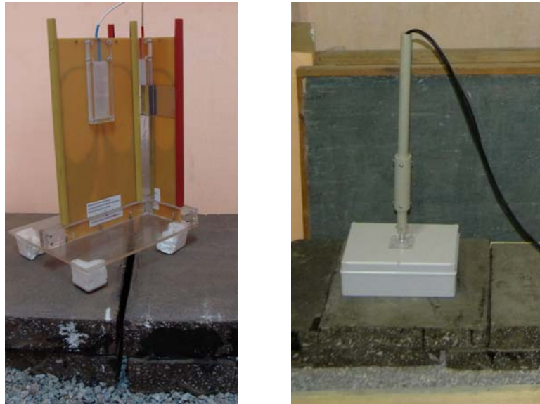
Рис.3 Антенные блоки георадара на модели дорожного покрытия: шель в двух слоях асфальтобетона и шель во втором слое асфальтобетона
