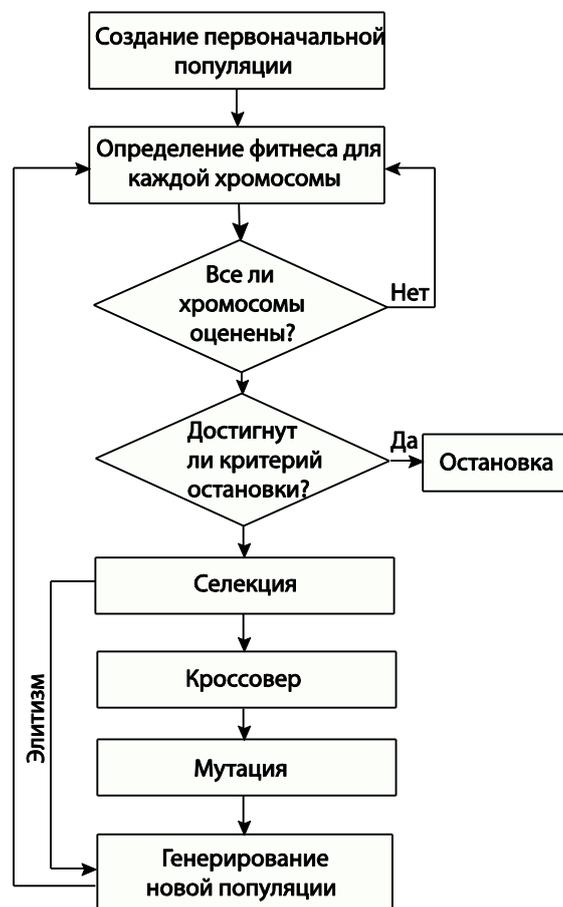
Рис. 2. Блок-схема генетической оптимизации.
