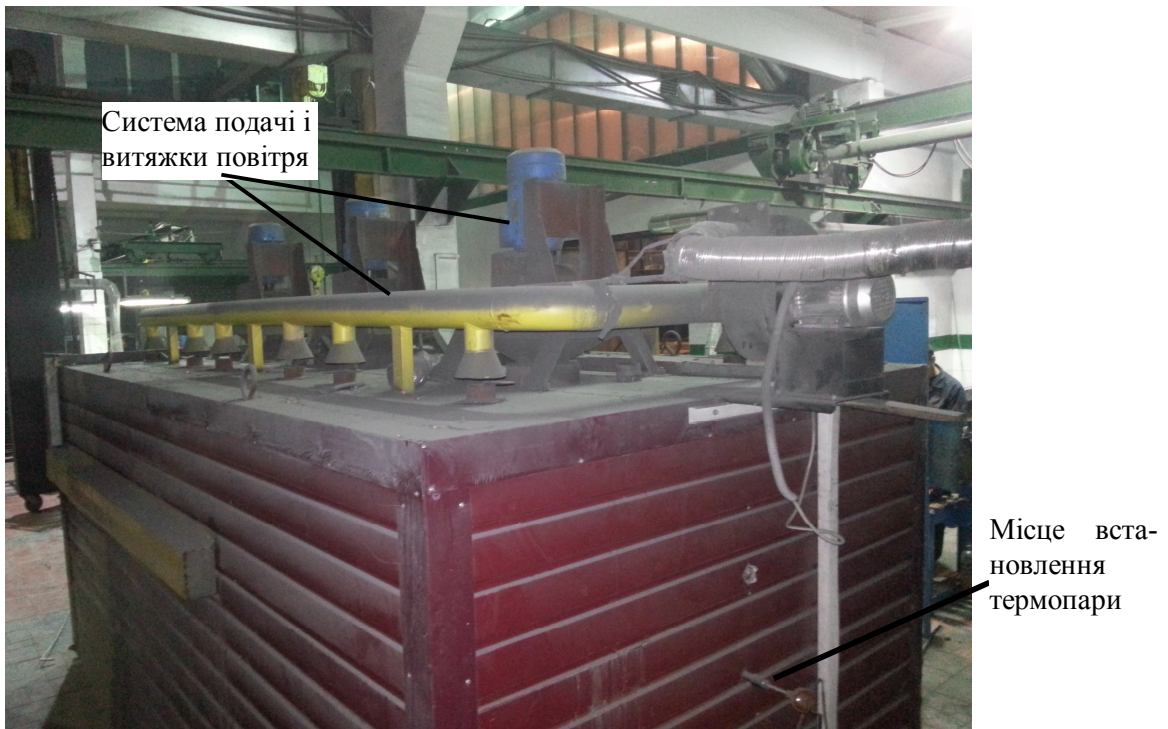
Рис. 2. Система подачі і витяжки повітря прожарювальної печі
