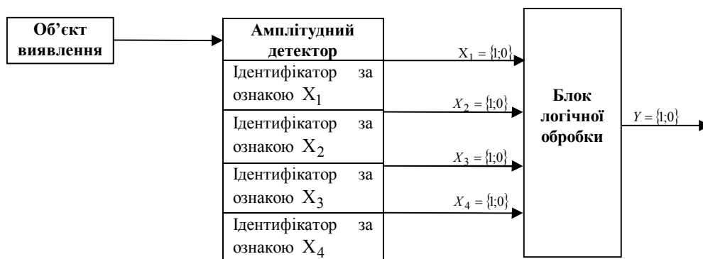
Рис. 2. Структура алгоритму обробки сигналу
