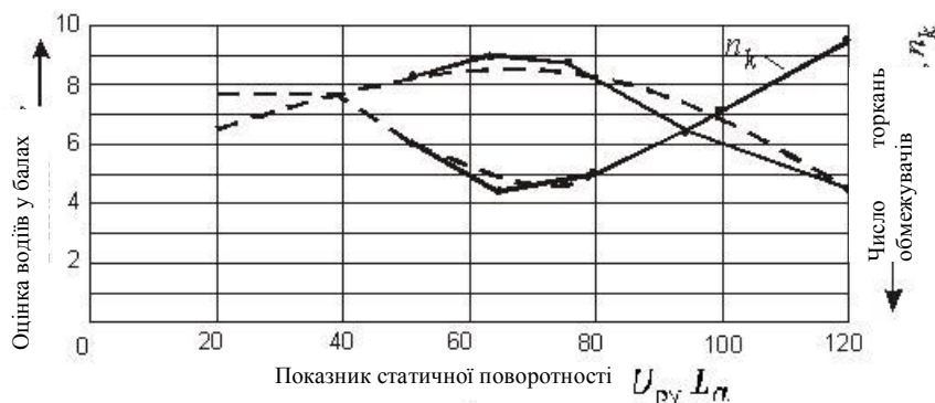
Рис. 5. Уплив параметра U_{py}L_a на оцінку керованості автомобіля
