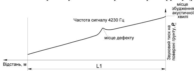
Рис. 3. Залежність зміни акустичного тиску на поверхні ґрунту над трубопроводом від довжини ділянки контролю на частоті сигналу 4230 Гц
