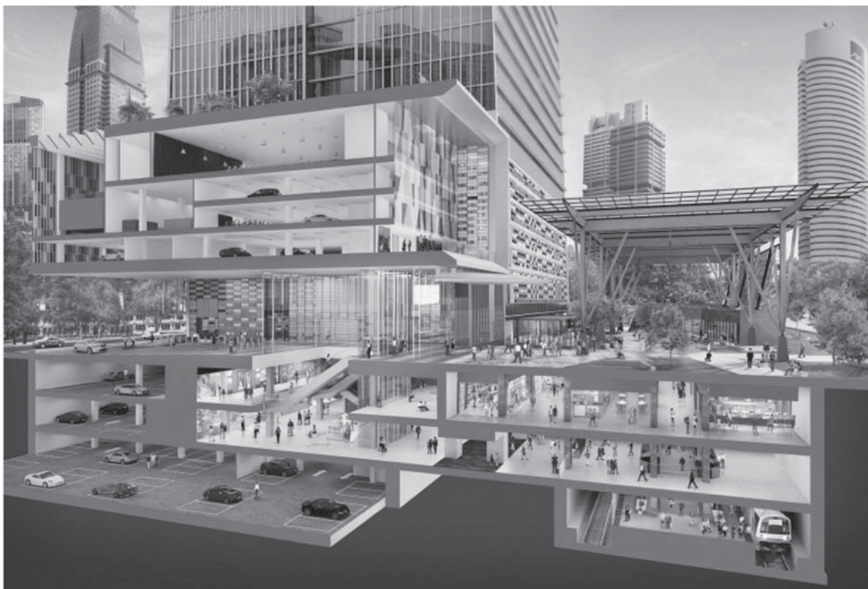
Рис. 3. Використання підземних просторів для організації громадських функцій у центральній частині міста. Проект багатофункціонального комплексу із житловою та громадською функціями у центральній частині м. Сингапур. SOM Designs [13]
